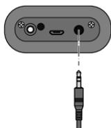
1. Verbinden Sie den Kopfhörer-Ausgang des Wiedergabegerätes über das beiliegende AUX-Kabel mit dem **AUX**-Anschluss am Lautsprecher.
