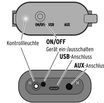
Kontrollleuchte ON/OFF Gerät ein-/ausschalten USB-Anschluss AUX-Anschluss
